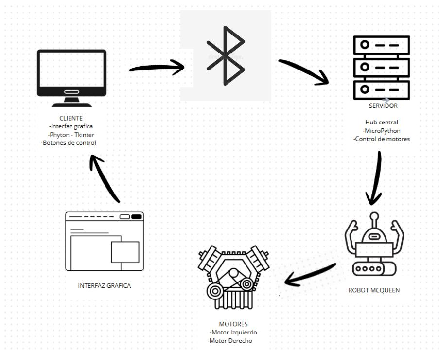
En el diagrama se puede observar como desde la GUI se envía un evento hacia el controlador del cliente y este envía un carácter a través de bluetooth y este llega al “servidor” que está en el hub y este decodifica el mensaje y lo envía a los motores
