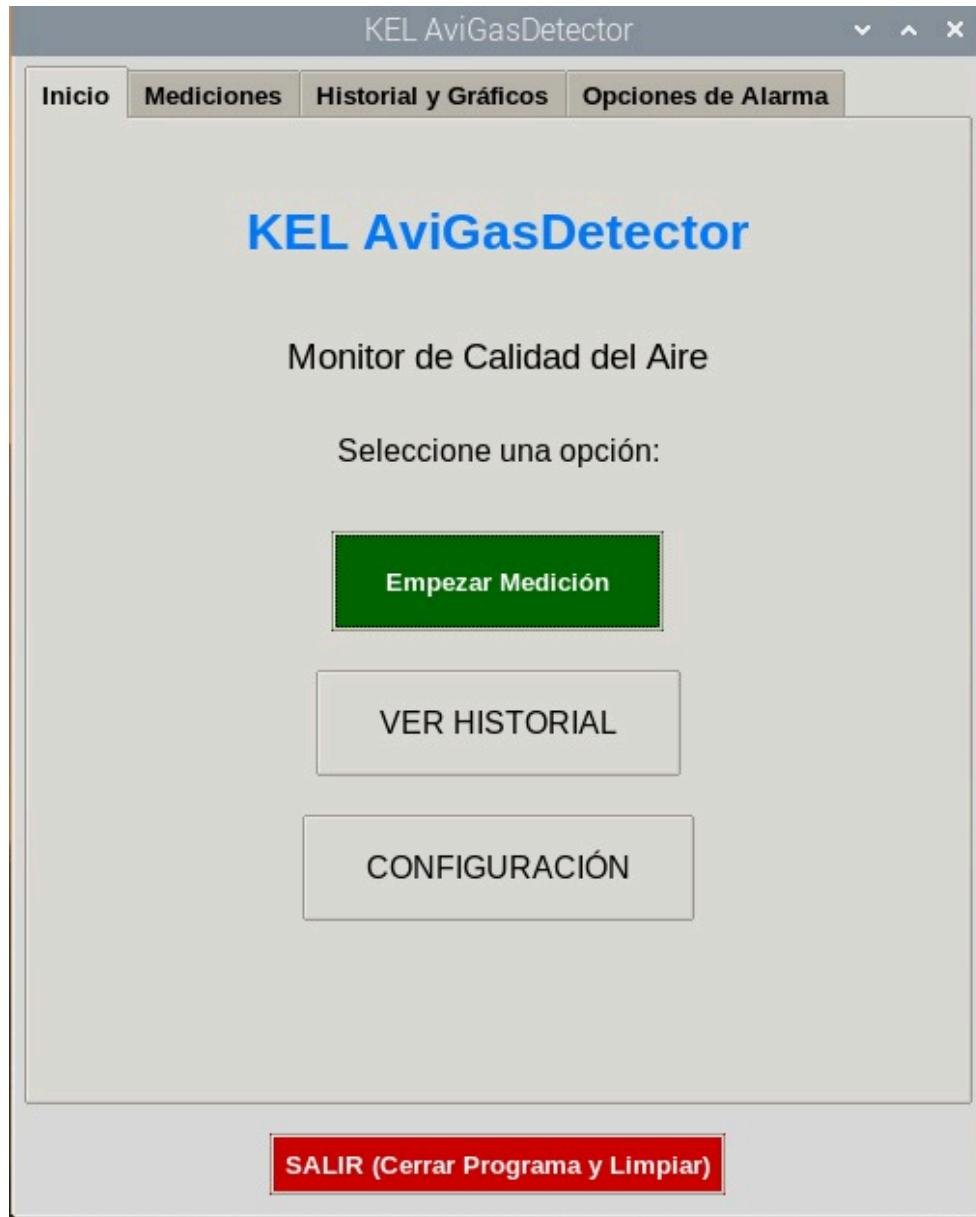
En la pantalla principal se puede observar 4 pestañas en la parte superior de la pantalla en donde el usuario podrá visualizar las mediciones en tiempo real, el Historial y gráficos y la configuración del umbral de las alarmas.
