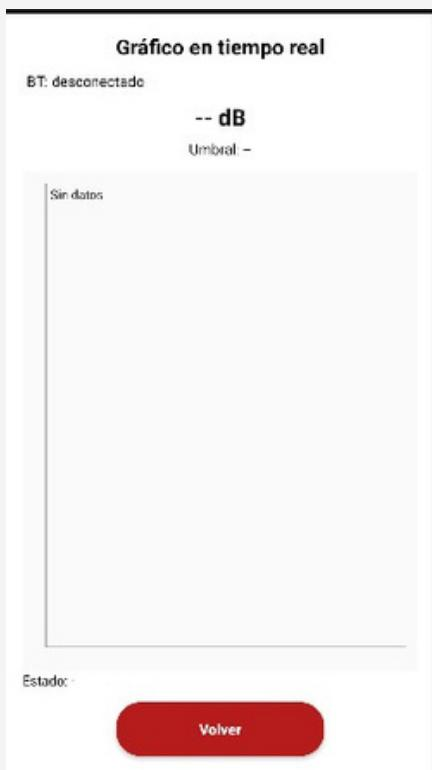
El gráfico en tiempo real representa la percepción del sonido captado por el sensor del micrófono de HUSH. Su función es dar detalles al usuario mediante una representación visual de los decibelios detectados, facilitando el monitoreo y la comparación de niveles de ruido en diferentes momentos del día.
