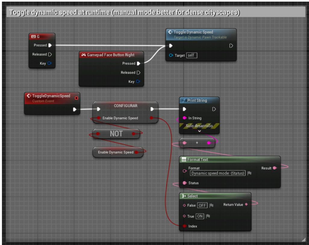
Este blueprint permite alternar la velocidad dinámica en tiempo real.
