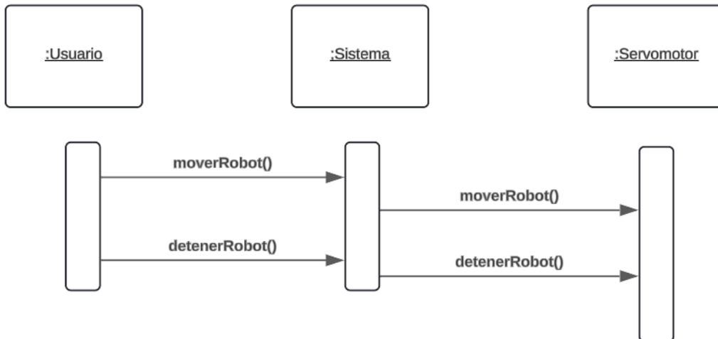
fig n°7: Diagrama de secuencia que modela el CUS mover robot.
