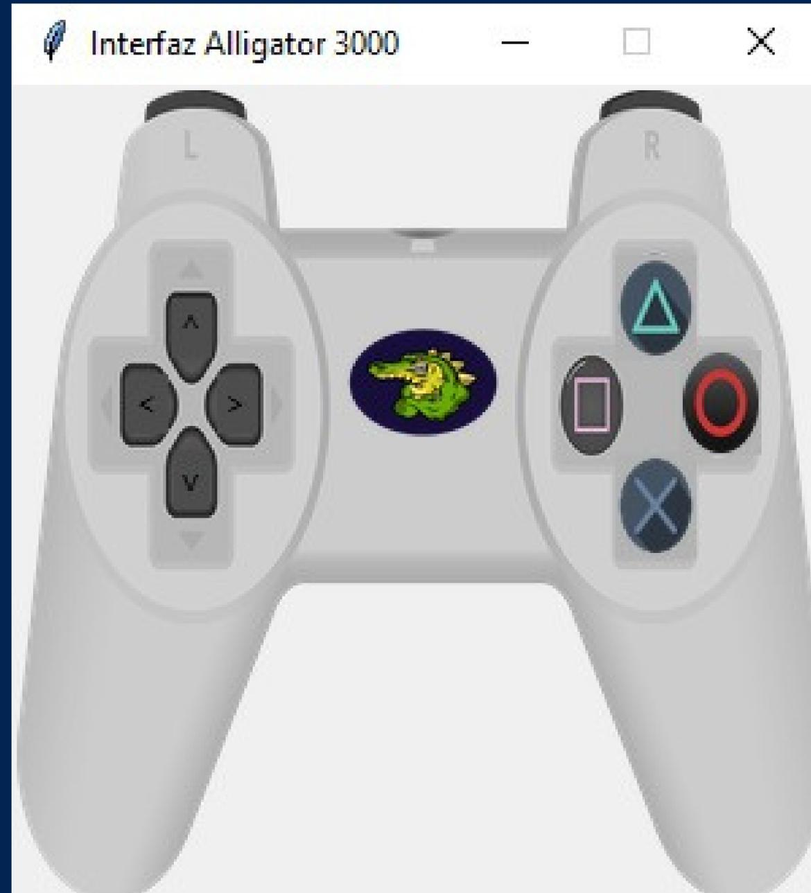
3. "Conectar", botón que contiene la "X" que establece la conexión entre el cliente y el servidor en el EV3
