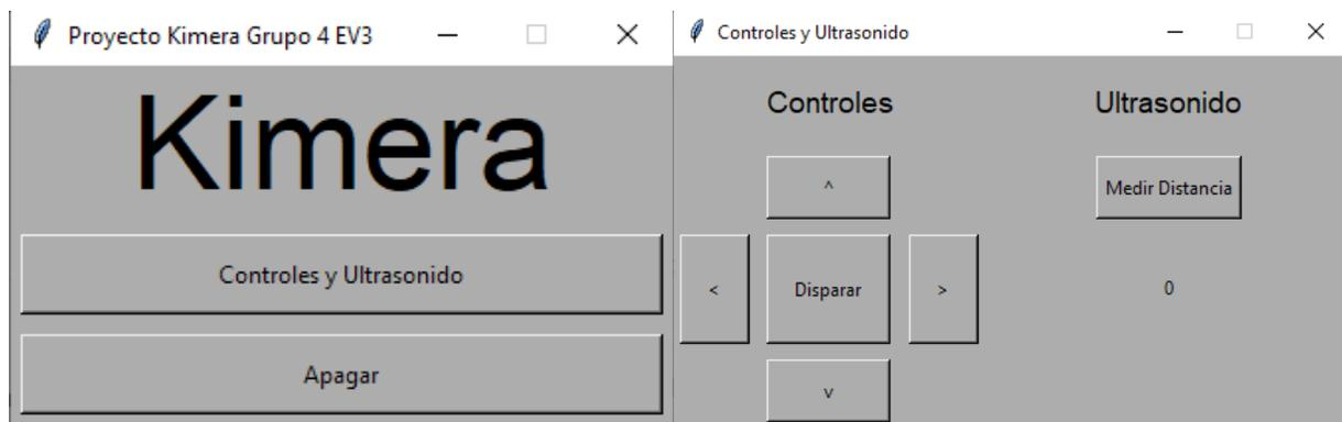
Al iniciar Kimera posee dos botones iniciales “Controles y Ultrasonido” que lleva al manejo del robot o medir la distancia con el ultrasonido, y el botón Apagar que cierra la ventana de la interfaz.
