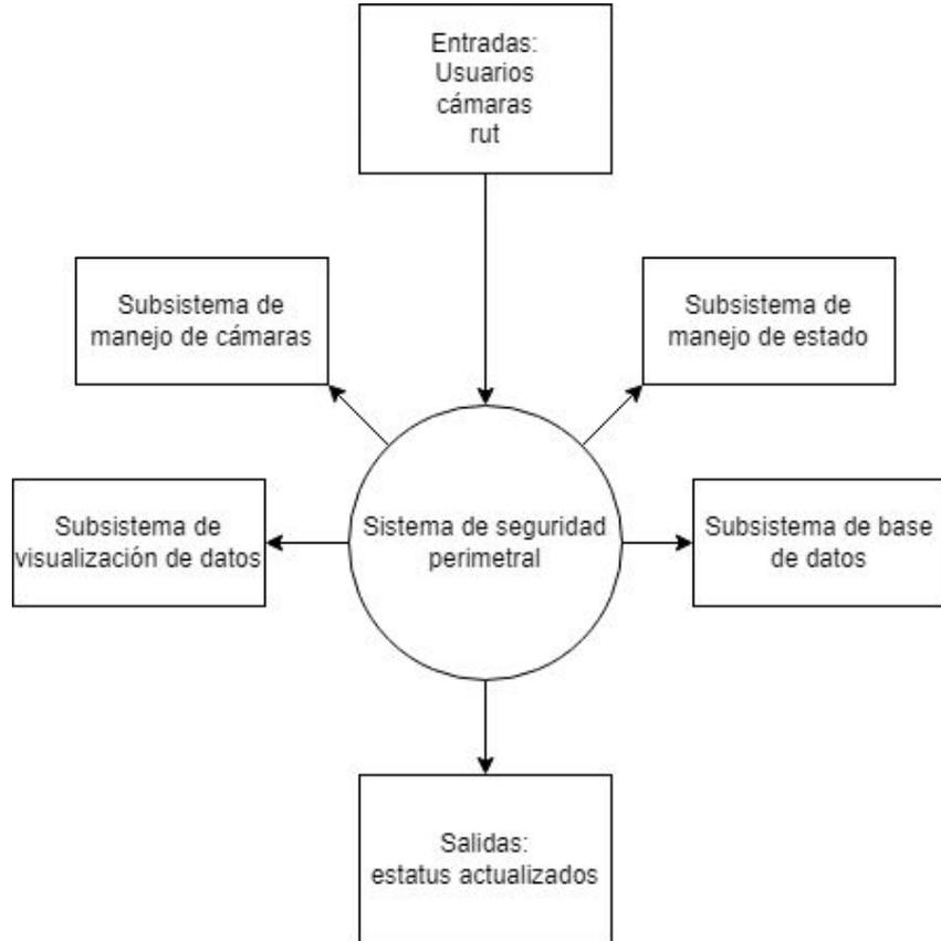
**Subsistema de manejo de manejo de cámaras:** Este es el encargado de gestionar las cámaras, conectarlas al sistema y permitir ver el contenido de estas.
