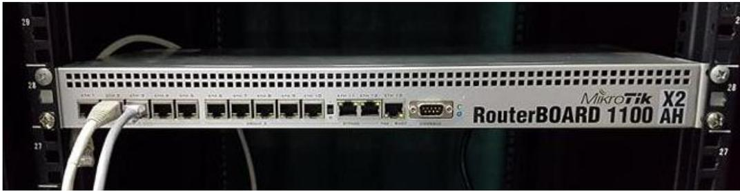
Figura 9. Fotografía de la RouterBoard 1100 Mikrotik con ambos computadores en la misma bridge.
