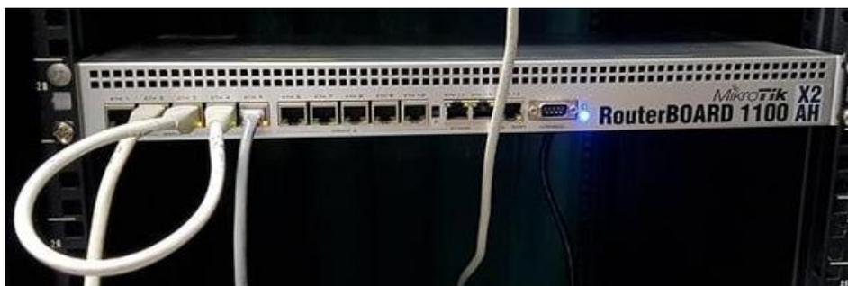
*Figura 13. Fotografía de RouterBoard 1100 Mikrotik con ambos computadores en distintas bridge y con un bridge entre ellos.*
