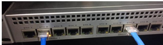
Ilustración 20. Conexión de PC's en distintas VLAN.
