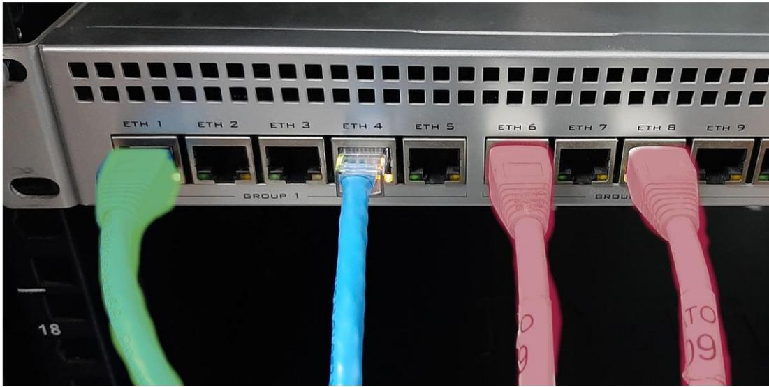
Ilustración 21 Adición de cable troncal entre las VLAN
